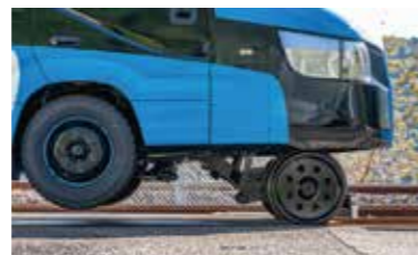
車体から鉄車輪が現れ鉄道モードへ、また鉄車輪を格納してバスモード。
