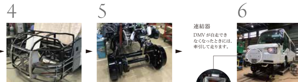
4 DMVの特微的なボンネットの骨組みはハンドメイドです。
